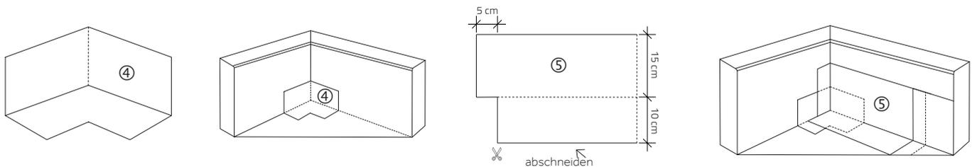
Icopal empfiehlt die Ausführung von Außen- und Innenecken mit den Vliesformteilen von Profi-Dicht speziell für Außen- bzw. Innenecken.
