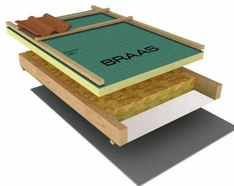
Kombination von Mineralwolle mit DivoDämm und DivoDämm Membran 4 unter den Sparren luftdicht angebracht.
