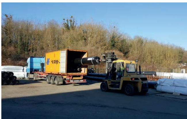
Pour le déchargement du conteneur, le même type de broche métallique peut être utilisé. Cette broche métallique peut être fixée sur la chargeuse-pelleteuse.
