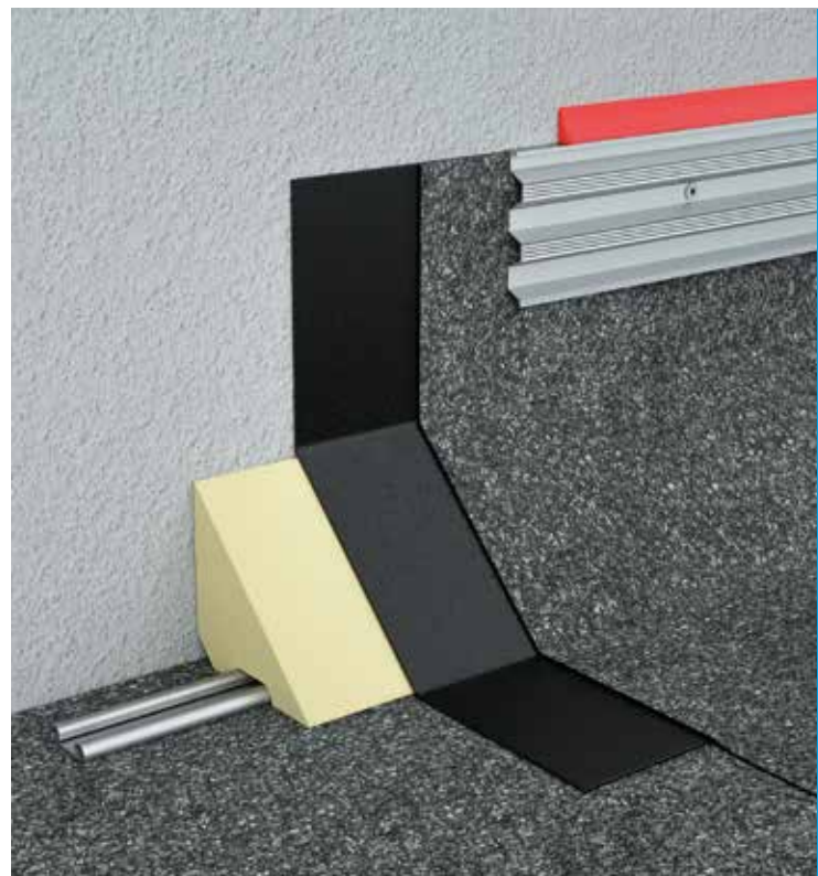
Versiegelung an einem Wandanschluss aus Bitumen
